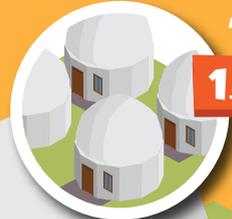
1. Membuat Rumah Dome, rumah yang konstruksinya dirancang mirip kubah dan tanpa sambungan agar tahan terhadap guncangan gempa.
